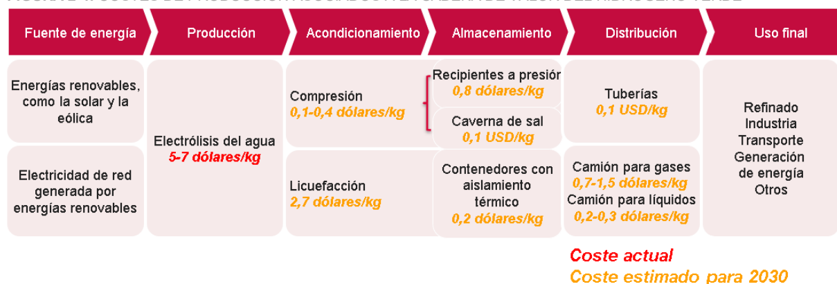
FIGURA 2-4: COSTES DE PRODUCCIÓN ASOCIADOS A LA CADENA DE VALOR DEL HIDRÓGENO VERDE
